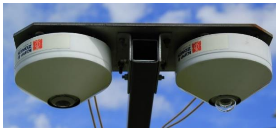
Рис. 2. Размещение пиргеометра, измеряющего E_d , на трекере (а) и пиргеометра, измеряющего E_g , на стойке (б)
