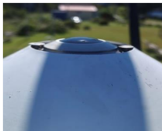
Рис. 2. Размещение пиргеометра, измеряющего E_d , на трекере (а) и пиргеометра, измеряющего E_g , на стойке (б)
