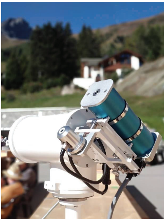
Рис. 2. Пиргелиометр (радиометр) РМО6 № 0817
