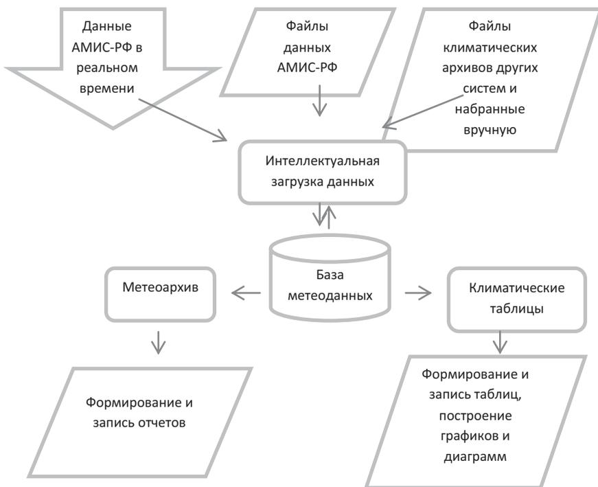
Рис. 7. Структурно-функциональная схема АРМ-Климат.
