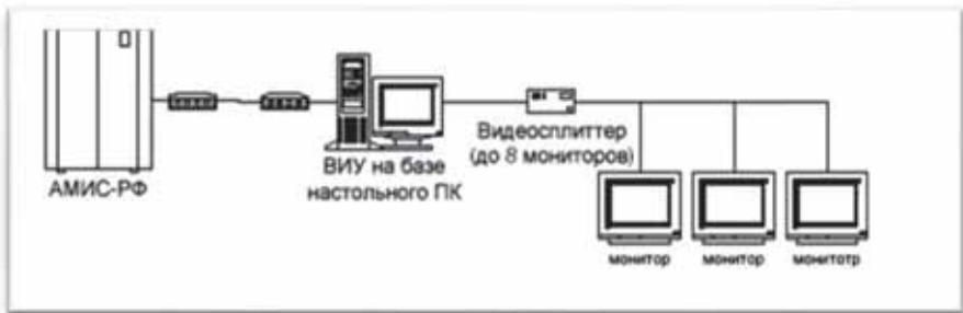
Рис. 3. Варианты подключения ВИУ к АМИС.
